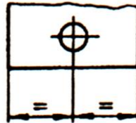
Slika 4.60. Označavanje centričnosti rupe
