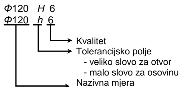
Slika 5.5. Način upisivanja tolerancija
